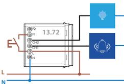
Tipo 13.22 - Relé multifunción, montaje en caja de mecanismos de 60 mm Ø o derivación
