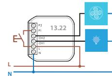
Función especial: RIa: telerruptor (mando con interruptor) ideal para convertir un sistema tradicional con interruptores de cruzamiento y desviadores en SMART
